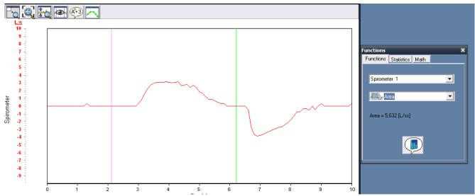
Eine Aus-, anschließend eine Einatmungsmessung mit dem Spirometer. Auf der y-Achse ist die Strömungsgeschwindigkeit in L/s auf der x-Achse die Zeit in s aufgetragen.
