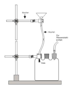
**Werkzeug:** 2 Stative, 3 Klammern, Woulffsche Flasche mit Stopfen , Wasserstrahlpumpe, kleiner Trichter, SERTO-Cutty,
