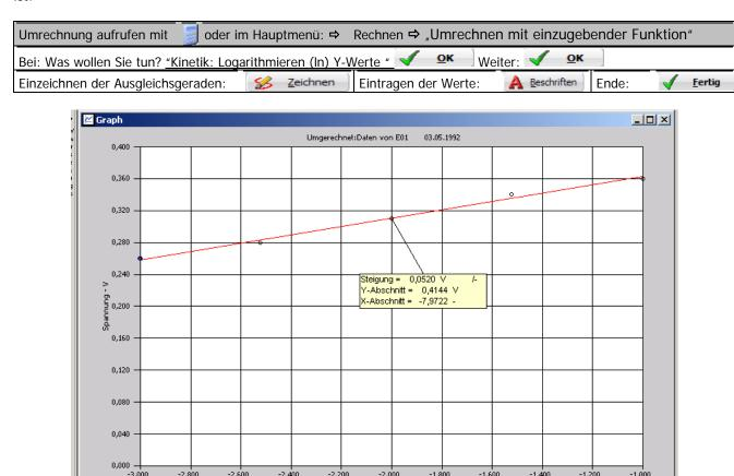
Auf dem Bildschirm erscheinen die Steigung (0.052 V) und der entsprechende y-Achsenabschnitt (0.414 V) der Ausgleichsgeraden, die man ausdrucken kann.
