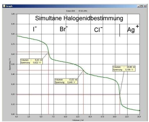
Die Äquivalenzpunktbestimmung muss dreimal durchgeführt werden. (Die Hilfslinien müssen nicht eingezeichnet werden, können aber später auch einzeln gelöscht werden).
