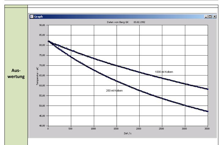
Wie man sieht, wird die Bergmann'sche Regel bestätigt. Der kleinere Kolben kühlt sich auf Grund des ungünstigeren Verhältnisses von Volumen zu Oberfläche schneller ab. Am Monitor ist der Effekt in Farbe natürlich noch deutlicher.
