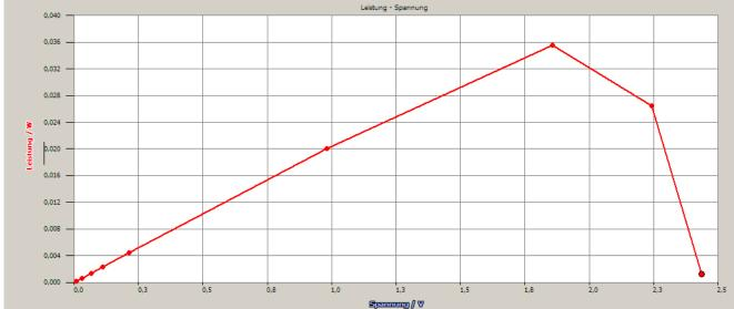
Am "Knickpunkt" der Kennlinie ist das Produkt aus Spannung (U) und Stromstärke (I), also die Leistung (P), maximal, weshalb man auch vom MPP (Maximum Power Point) spricht.
