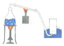
Links wird Wasserdampf erzeugt. Die durch den Wasserdampf verdrängte Luft gelangt in die mit Wasser gefüllte Spritze ("pneumatische Wanne"). Weil der Wasserdampf in dem Wasser kondensiert, müssen die Bläschen Luft sein. Steigen keine Bläschen mehr auf, wird der Standzylinder wieder vollständig mit Wasser gefüllt. Das Magnesiumband wird mittels Gasbrenner entzündet. Der Versuch lässt alternativ sich auch mit AK SÜS-Teilen durchführen.
